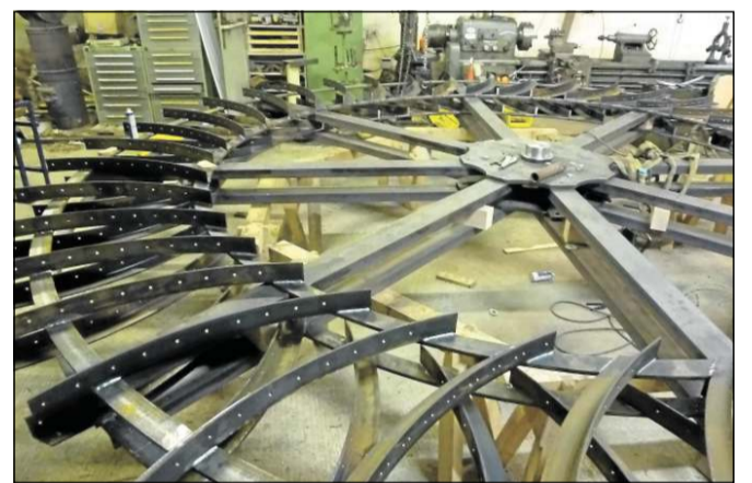
Gewaltige Ausmaße: Das in Süddeutschland hergestellte Was- serrad mit einem Durchmesser von sechs Metern wird in diesen Tagen in seinen Einzelteilen nach Geseke transportiert.
